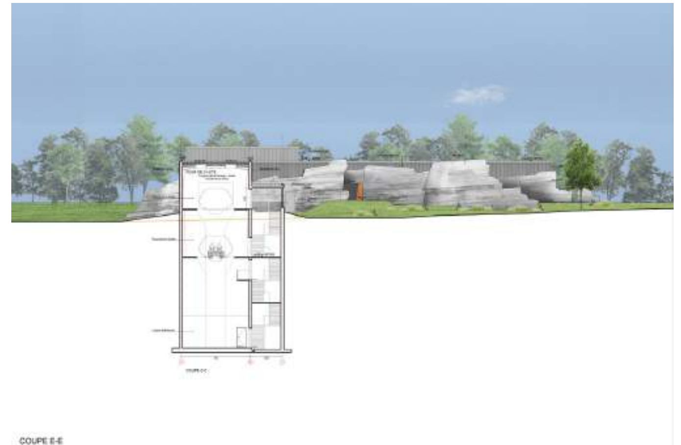
Figure 9 : Schéma d'illustration du surcreusement de la chambre de chute par rapport au terrain naturel
